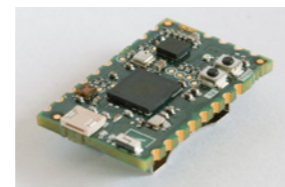
NTSecureNode BLE100 Datenerfassungsplattform für stationäre IoT-Netzwerke
