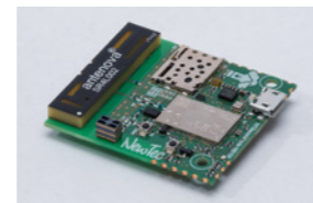
NTSecureNode NB100 Datenerfassungsplattform für großflächige IoT-Netzwerke (LTE NB-IoT)
